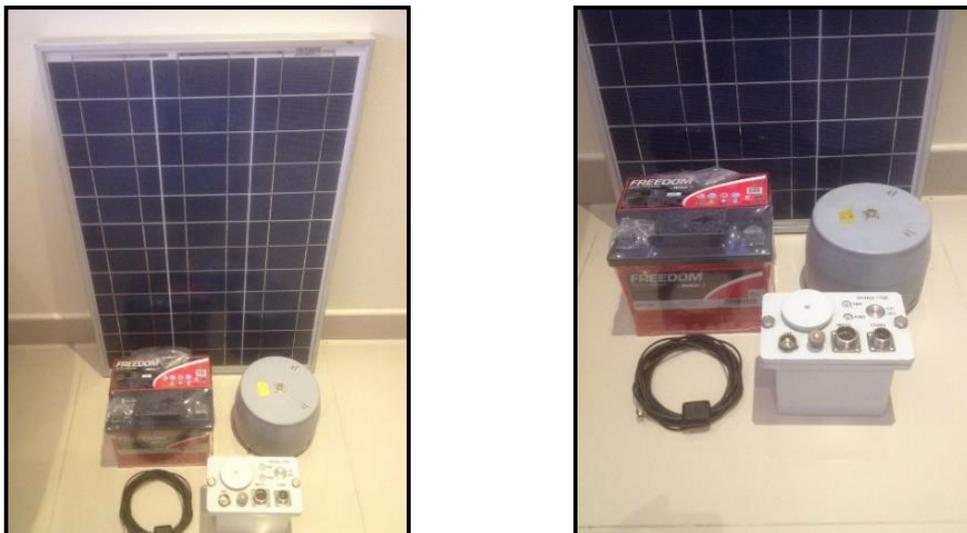
**Figura 07:** Conjunto de equipamento incluindo o sismógrafo e registrador da R-Sensors, bateria estacionária e placa fotovoltaica 60W, instalados na estação LGZ 02.
