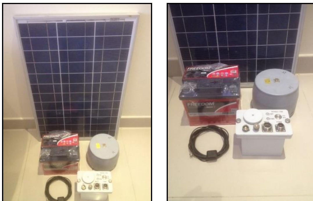
Figura 04: Conjunto de equipamento incluindo o sismógrafo e registrador da R-Sensors, bateria estacionária e placa fotovoltaica 60W, instalados na estação LGZ 02.
