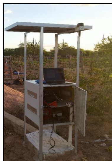
Figura 07: Instalação do sismógrafo na estação LGZ 02.
