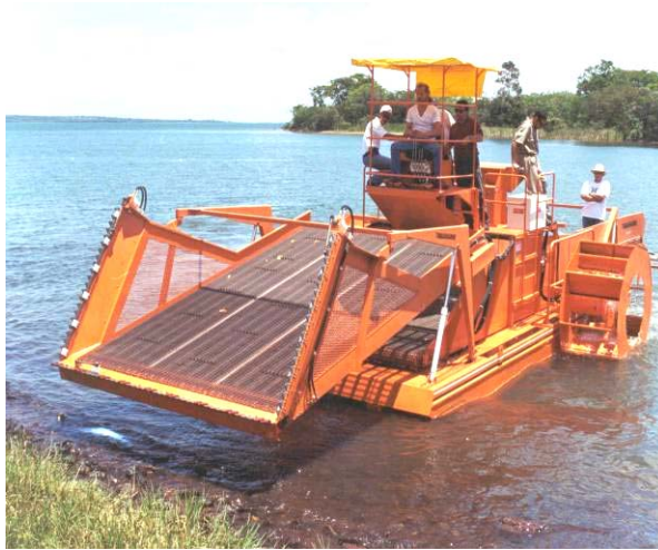
FIGURA 31 – Colheitadeira Aquamarine, utilizada para controle mecânico das plantas aquáticas
