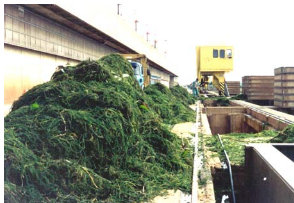
FIGURA 29 - Material colhido pelo pórtico limpa-grades da UHE Eng. Souza Dias (Jupiá).
