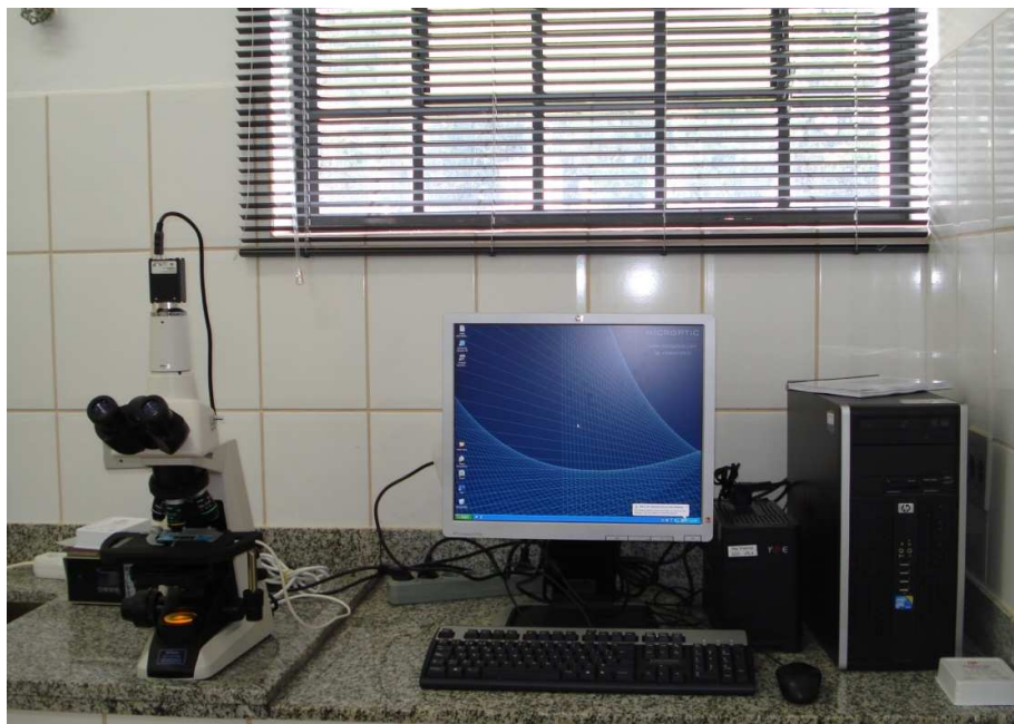
Figura 3 Equipamentos que compõe o sistema CASA ( computer-assisted sperm analysis ) - um microscópio óptico de contraste de fase com câmera acoplada, conectado a um computador com o software instalado. Laboratório de tecnologia de sêmen – DZO/UFLA
