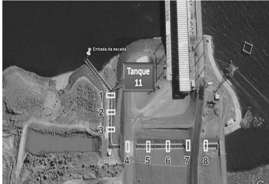
**Fig. 2.** Distribuição das antenas ao longo da escada para peixes da UHE Engenheiro Sérgio Motta. Localização do tanque 11.
