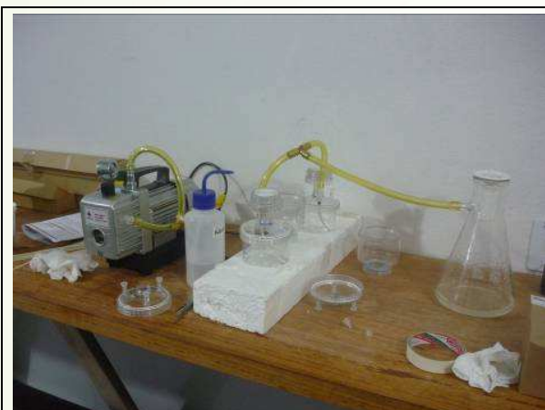
Foto 6.17 – Conjunto de filtragem Nº 2
