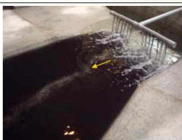
Foto 6.32 – Detalhe do sistema de injeção de sedimentos no modelo
