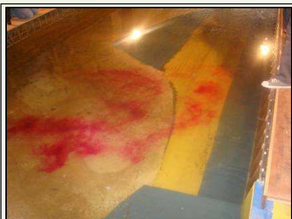
Foto 6.25 – Corante indicando corrente de fluxo próximo a tomada d’água
