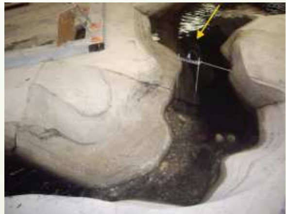
Foto 6.34 – Pontas linimétricas para medição do nível d'água
