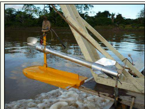
Foto 6.3 – Molinete e lastro utilizado nas medições de vazão líquida
