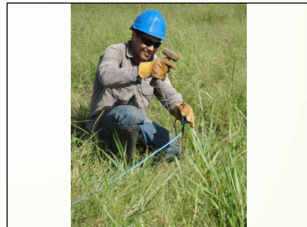
Foto 4 – Fixação do eletrodo.
