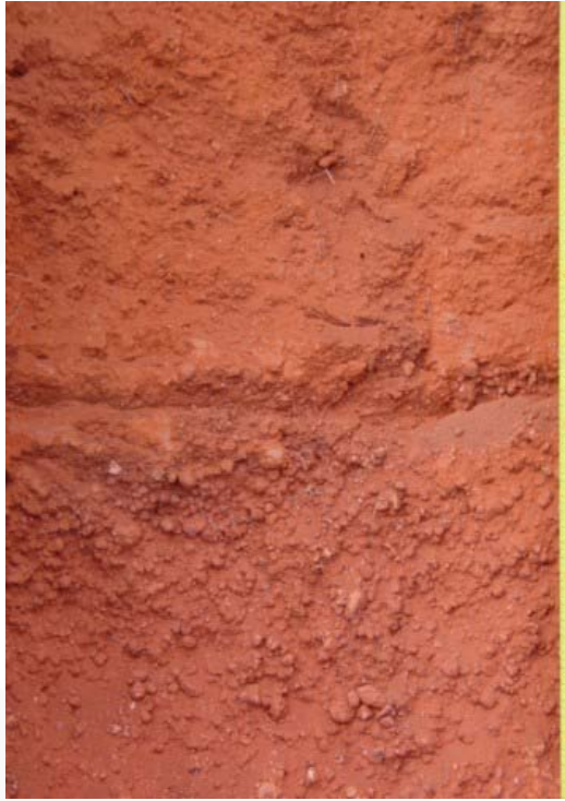
Figura 1 – Detalhe de horizonte plântico característico dos Plintossolos Petroplânticos observados na região da AHE Jirau.
