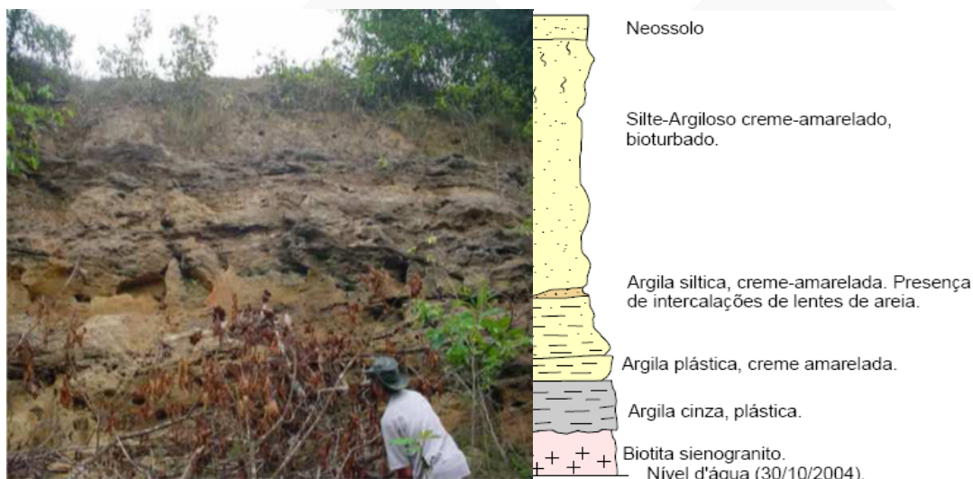
Figura 5 – (esquerda) camada de areia estratificada e ferruginizada em barranco do Rio Jaciparaná. (Direita) Perfil esquemático da Formação Jaciparaná.
