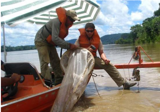
Figura 1. Utilização de rede ictioplâncton, com formato cônico-cilíndrico, para coleta de ovos e larvas.
