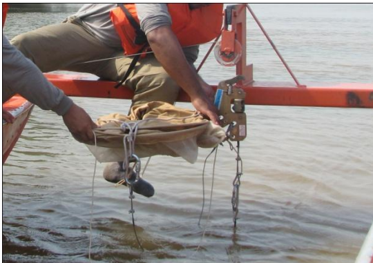
Figura 3. Detalhe do acoplamento da rede de ictioplâncton ao mecanismo de duplo estágio.
