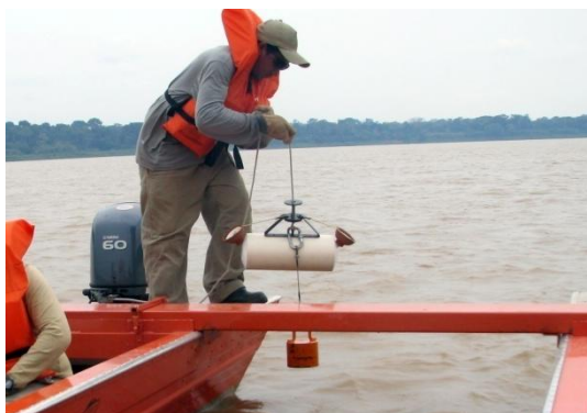
Figura 7. Utilização de garrafa tipo Van Dorn para coleta de água em diferentes profundidades.
