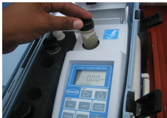
**Figura 6.** Utilização de turbidímetro para leitura da turbidez.
