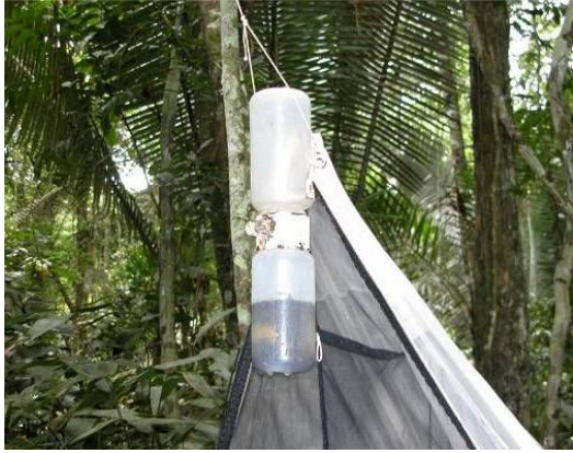
Foto 3 Detalhe da câmara de vôo e do copo coletor de insetos contendo álcool
