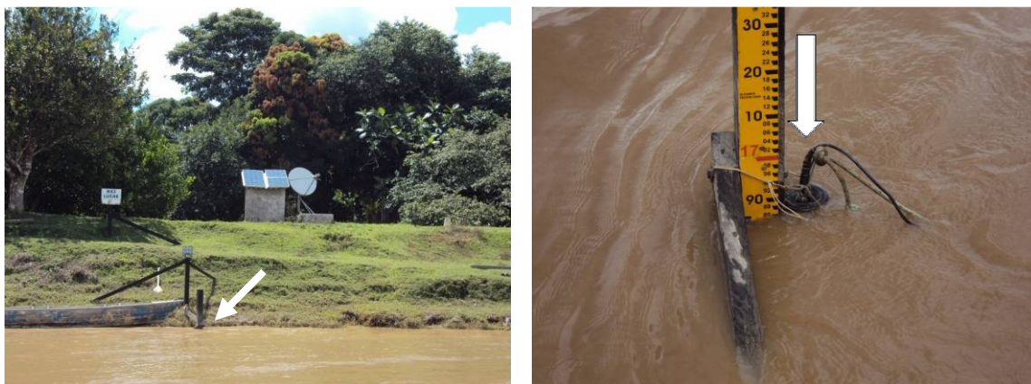
Figura 49. Local onde a sonda multiparamétrica do sistema de monitoramento em tempo real está fixada na margem direita do rio Madeira (RS 3 - Lucas), a jusante da futura barragem do AHE Jirau. As setas indicam o ponto no qual a sonda multiparamétrica permanece fixada.
