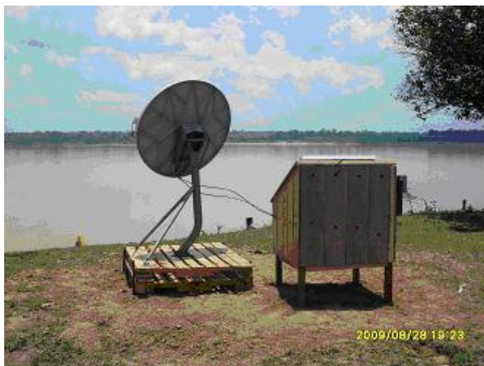
Figura 46. Antena de transmissão e abrigo temporários do sistema de monitoramento em tempo real instalados na margem do rio Madeira (RS 3 - Lucas).
