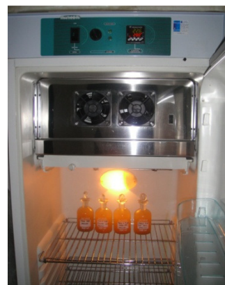
Foto 24. Análise de DBO_5 no laboratório base, localizado no canteiro de obras do AHE Jirau.
