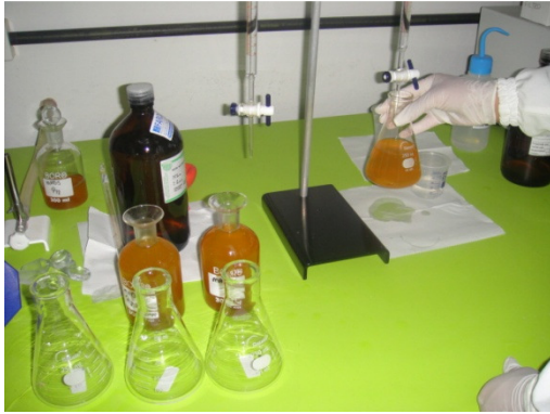
Foto 25. Análise da concentração de oxigênio pelo método Winkler, no laboratório base, localizado no canteiro de obras do AHE Jirau.
