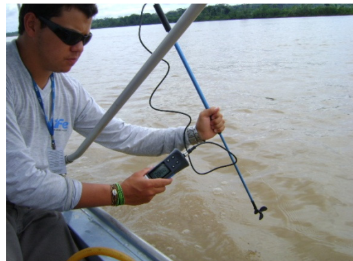
Foto 20. Medida da velocidade da água realizada no dia 08/01/2010 no ponto P18 (rio Madeira).
