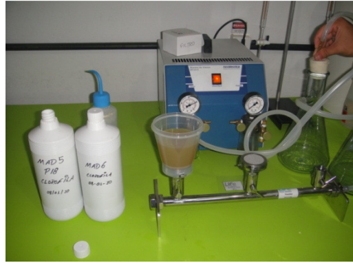
Foto 26. Filtragem de água para posterior análise de clorofila- a .
