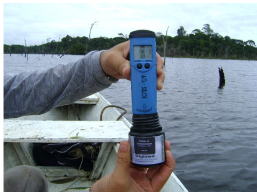
Foto 16. Calibração dos aparelhos condutivímetro e pHmetro realizada em campo no dia da coleta.
