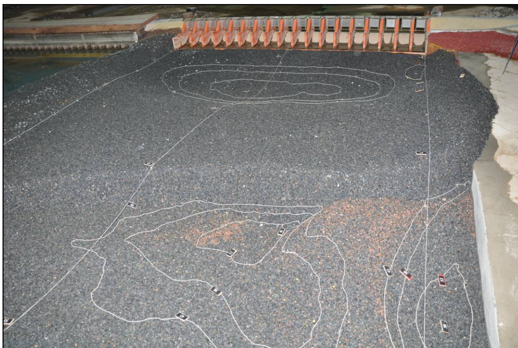
Figura 3.1. Erosões a jusante do vertedouro – TR 10.000 anos.
