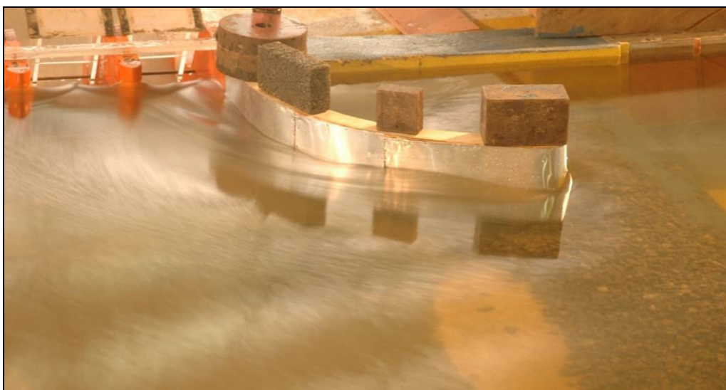
Foto 3.7. Detalhe das condições de aproximação pelo lado direito – Q = 81.899 \text{ m}^3/\text{s} – Alternativa 7.
