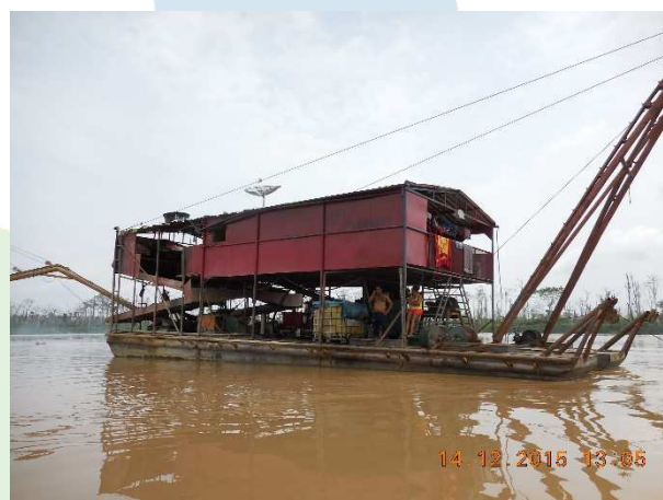
Foto 4-4 – Dragagem CFV (não cadastrada). Dragagem com porte reduzido em relação às demais.
