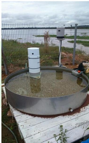
**Foto 5-1** – Estação Evaporimétrica
