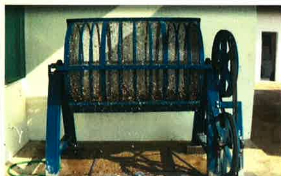
Foto 03 – Terceira Etapa DESCASCAMENTO AUTOMÁTICO EM CONFORMIDADE
