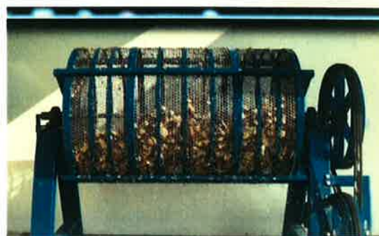
Foto 04 – Terceira Etapa DESCASCAMENTO AUTOMÁTICO EM CONFORMIDADE
