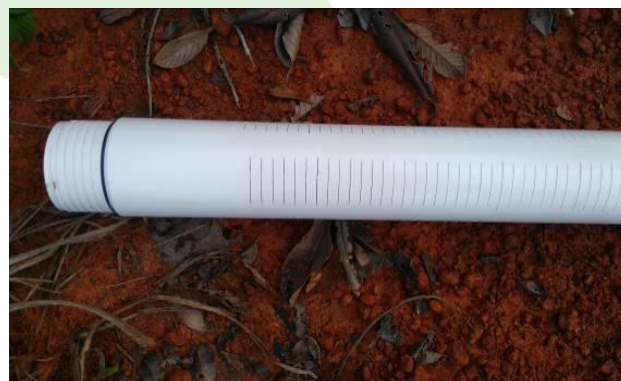
Foto 4-2 – Detalhe filtro de PVC geomecânico.
