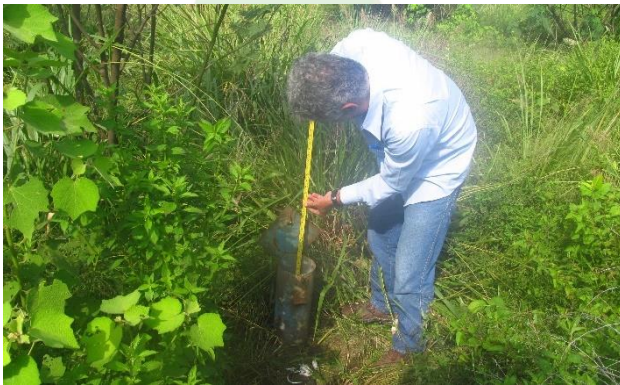
Foto 4-9 – Procedimento de medição do NA com régua graduada realizado no PZ-02.
