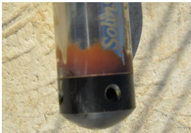
Foto 9-1 – Formação de crosta ferruginosa em medidor ( levellogger ).
