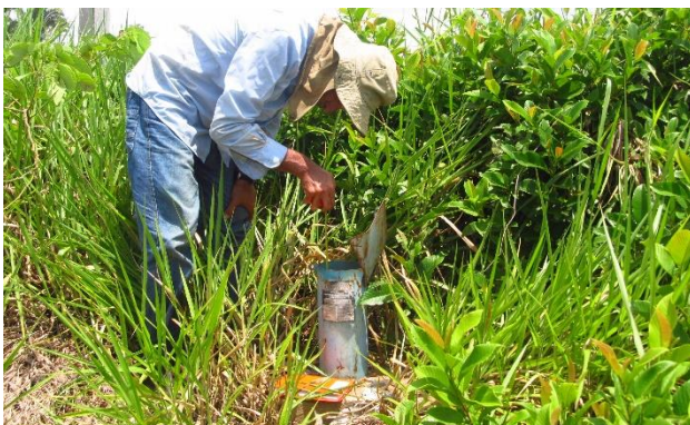
Foto 4-11 – Procedimento de medição do NA com régua graduada realizado no PZ-27.
