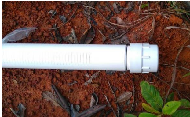
Foto 4-3 – Detalhe filtro PVC geomecânico com tampa rosqueável de PVC.
