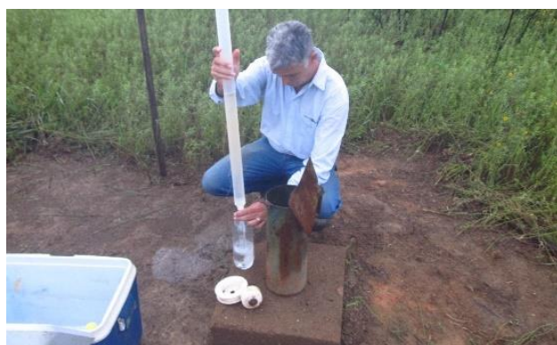
Foto 4-15 – Detalhe de procedimento de amostragem do poço Pz-26 (Dez/2015).
