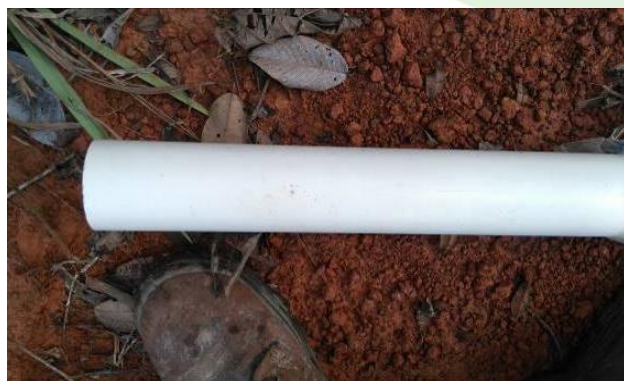
Foto 4-1 – Detalhe do tubo de PVC geomecânico (revestimento).
