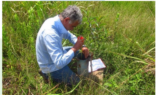
Foto 4-10 – Procedimento de medição do NA com régua graduada realizado no PZ-13.
