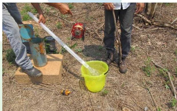
Foto 4-14 – Procedimento de medição do NA com régua graduada realizado no PZ-14.
