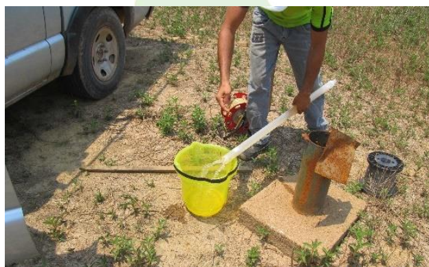
Foto 4-13 – Detalhe do Procedimento de purga para limpeza dos poços.
