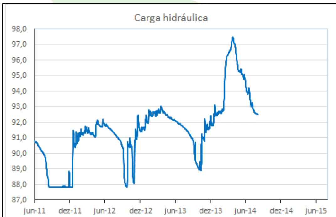
Gráfico 18 - Carga hidráulica do PZ-09 no período de 02/06/2011 a 01/08/2014.
