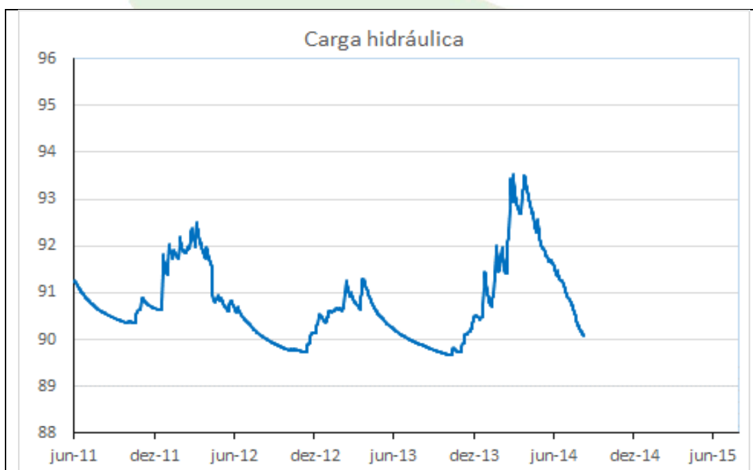
Gráfico 56 - Carga hidráulica do PZ-28 no período de 01/06/2011 a 09/08/2014.
