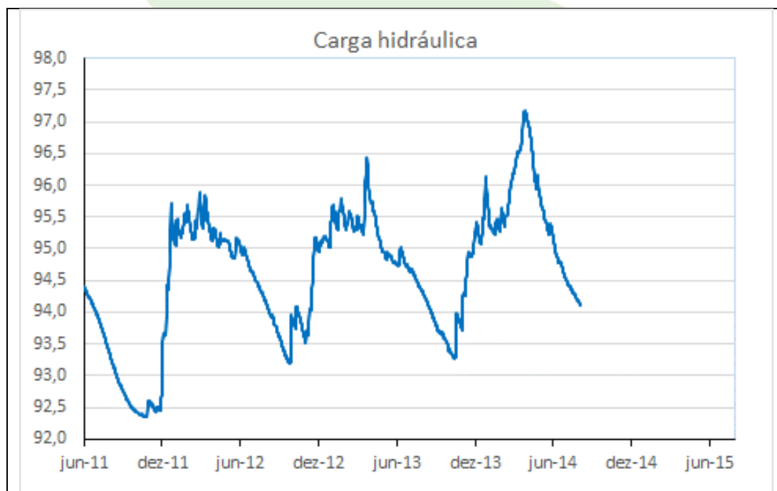
Gráfico 24 - Carga hidráulica do PZ-12 no período de 01/06/2011 a 02/08/2014.
