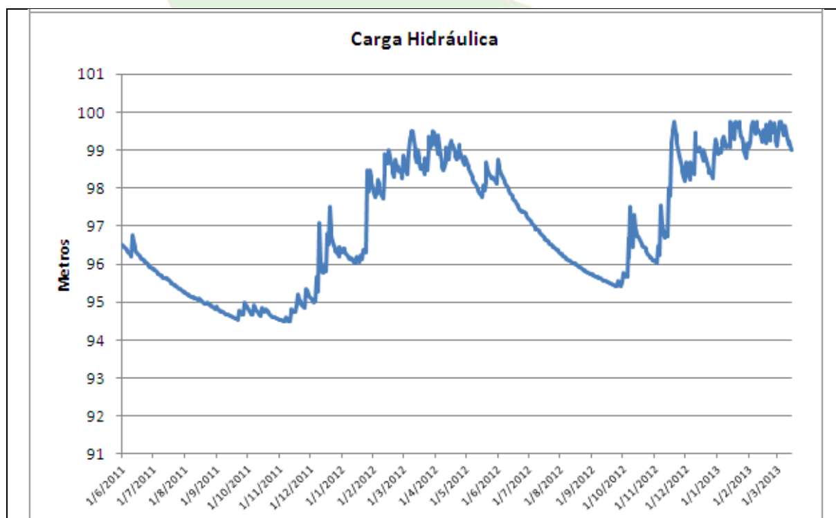
Gráfico 6 – Carga hidráulica do PZ-03 no período de 01/06/2011 a 01/03/2013
