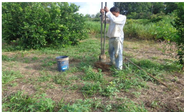
Foto 2-5 – Coleta de amostra de solo para análise na EMBRAPA no lote RRC-01 referente à UD de Fruticultura na data de 05/01/2016.
