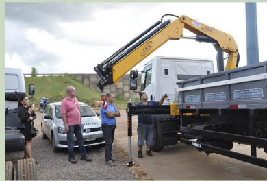
O caminhão Munck possui capacidade de levantar cerca de dez toneladas
