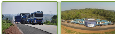
O estator de 250 toneladas e 10 metros de diâmetro foi transportado da China ao Brasil
