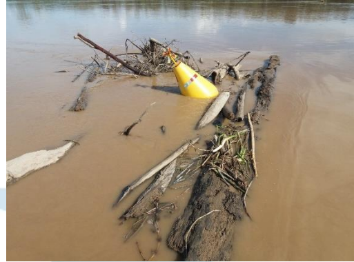
Foto 2-4 – Flutuador com acúmulo de troncos que podem danificar o equipamento de telemetria, arrastar ou afundar o sistema
