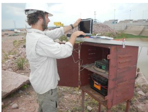
Foto 2-1 - Download dos dados e manutenção de base fixa de radiotelemetria a montante do vertedouro da UHE Jirau
