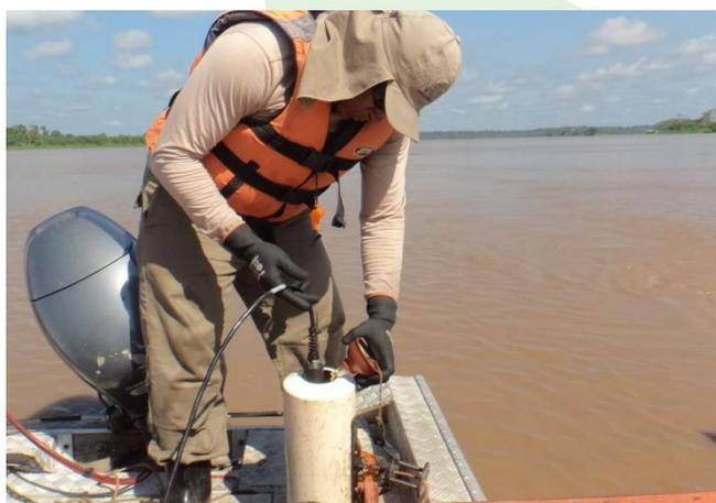
**Foto 4-5** - Coleta de dados limnológicos com a utilização da Sonda Multiparamétrica e o auxílio da Garrafa de Van Dorn.
