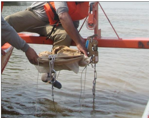
Figura 4.3.6. Detalhe do acoplamento da rede de ictioplâncton ao mecanismo de duplo estágio.
