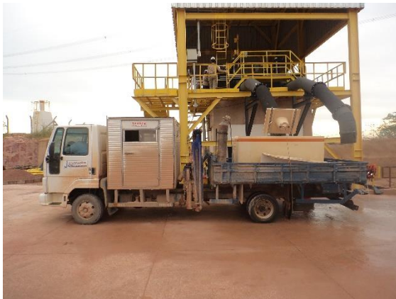
Figura 4.4.9. Caixa para transporte de peixes vivos, com capacidades de 2.400 litros, colocada sobre o caminhão.
