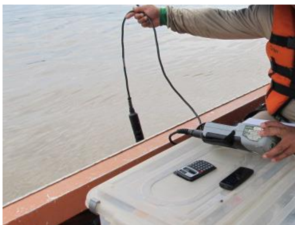
Figura 4.1.10. Medição das variáveis limnológicas com o auxílio da sonda multiparamétrica nos pontos amostrados.
