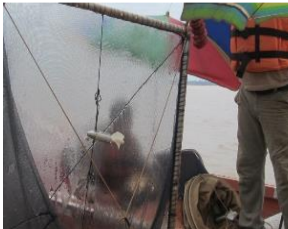
Figura 4.3.7. Detalhe do posicionamento do fluxímetro mecânico no centro da rede de coleta de juvenis.
