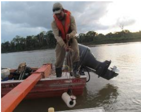
Figura 4.3.10. Utilização de garrafa tipo Van Dorn para coleta de água em diferentes profundidades.
