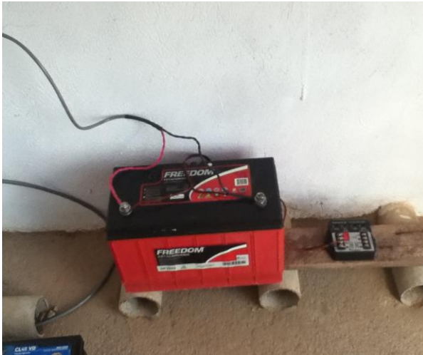
Foto 18 - Bateria estacionária Freedom de 12 V e 70 Ah, para alimentar o sismógrafo de JIR2.
