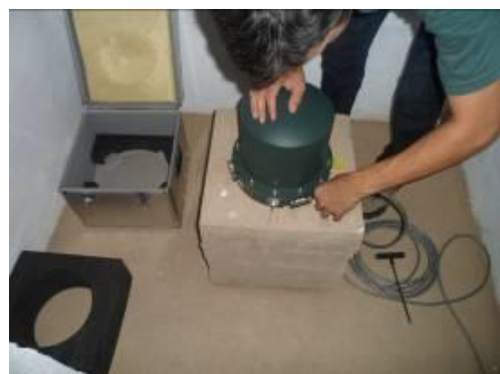
Foto 13 – Instalando o sensor.
