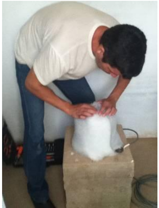
Foto 15 – O sensor está sendo isolado com lã de vidro contra mudanças bruscas de pressão e de temperatura.
