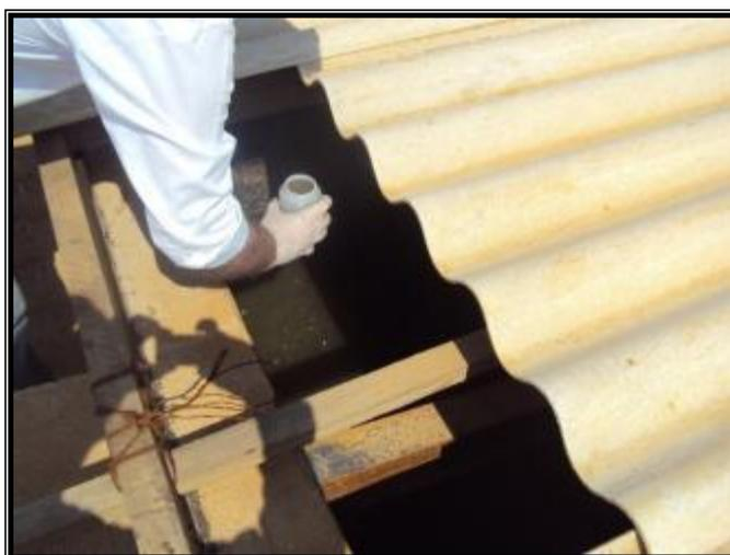
**Figura 22-** Coleta de amostra do efluente bruto na entrada da ETE.
