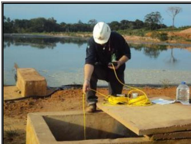
**Figura 25-** Medição do efluente através da sonda HQ40D da marca Hach.
