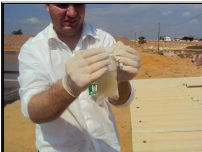
**Figura 23-** Coleta de amostra para coliformes totais e termotolerantes.
