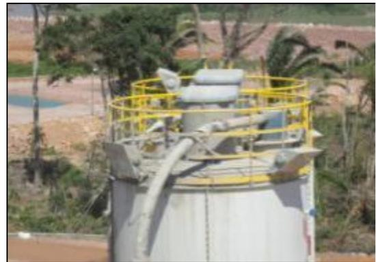
Foto 04: Detalhe dos cabeçotes que contém filtros do tipo manga.
