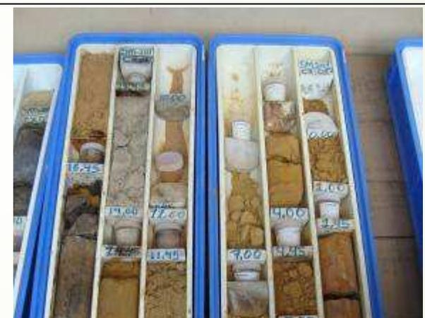
Foto 18 – Amostras de testemunho de sondagem (04/06/2010).
