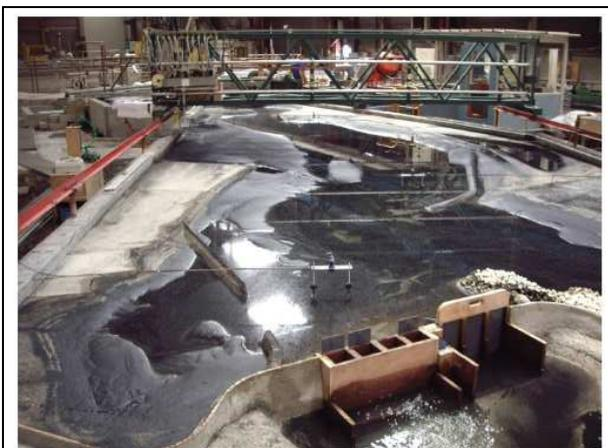
Foto 6.23 – Ensaio com vazão de 6000 m<sup>3</sup>/s
