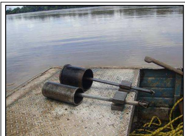
Foto 6.5 – Amostrador de sedimento do tipo caçamba
