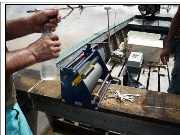
Foto 6.2 – Guincho fluviométrico existente na embarcação
