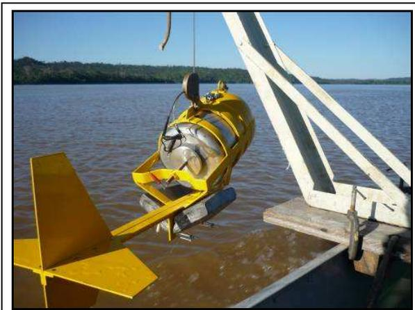
Foto 6.4- Amostrador de sedimento tipo saca
