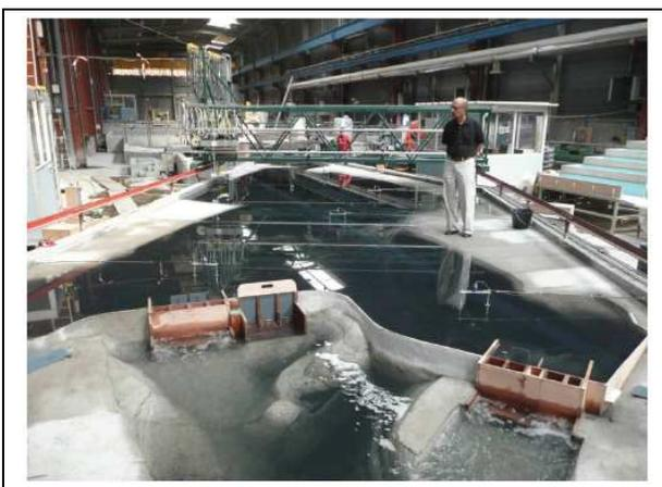
Foto 6.25 – Ensaio com vazão de 15000 m<sup>3</sup>/s
