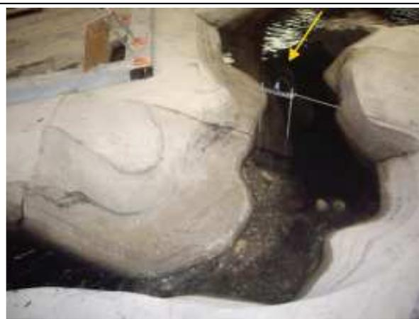
Foto 6.16 – Pontas linimétricas para medição do nível d'água
