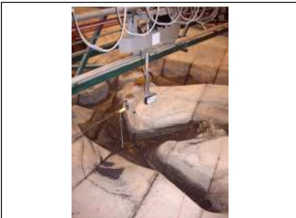
Foto 6.15 – Sistema de medição do sedimento depositado no leito
