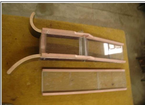
Foto 6.27 – Detalhe do descarregador de troncos
