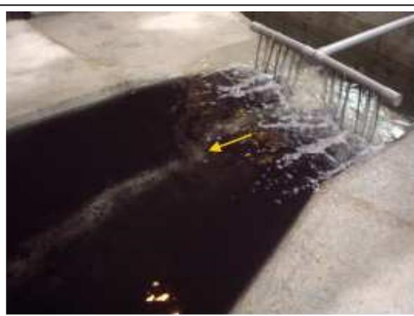
Foto 6.14 – Detalhe do sistema de injeção de sedimentos no modelo
