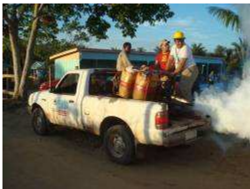
Foto 139 - Termonebulizador em operação
