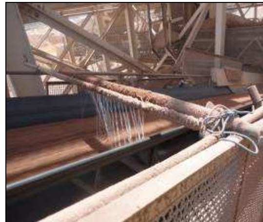
Imagem 46 – Aspersores de água nas unidades de britagem
