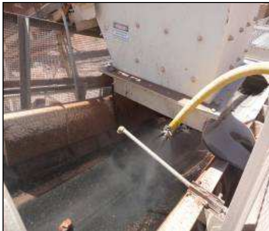
Imagem 46 – Aspersores de água nas unidades de britagem
