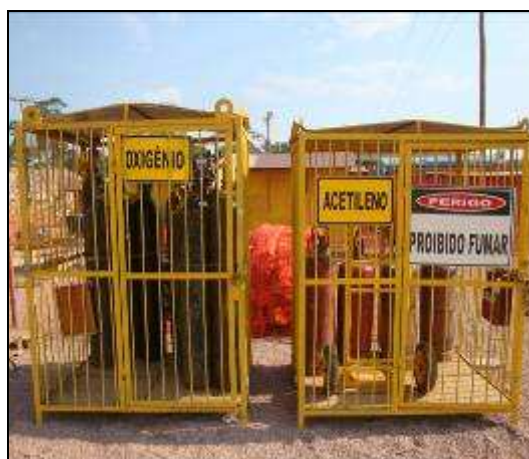
Imagem 63 – Armazenamento de gases comprimidos
