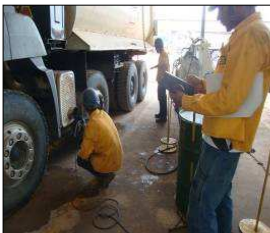
Imagem 48 – Medição grau enegrecimento com instrumento apropriado
