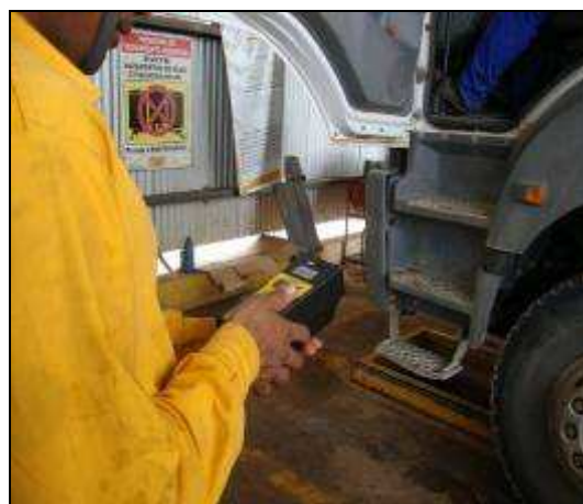
Imagem 48 – Medição grau enegrecimento com instrumento apropriado
