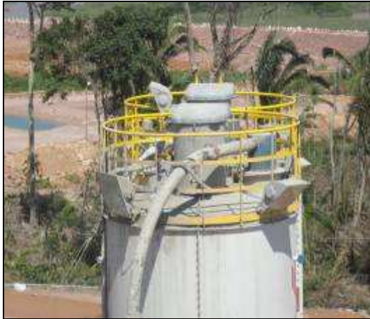
Imagem 47 – Filtros de manga nas usinas de concreto
