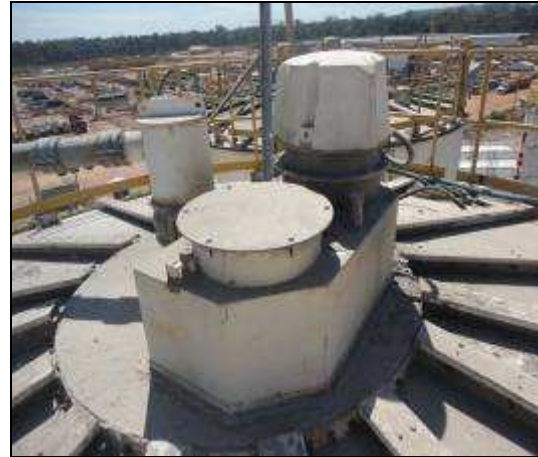
Imagem 47 – Filtros de manga nas usinas de concreto
