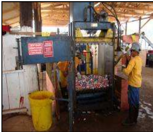
Imagem 36 – Processo de reprocessamento de resíduos na UTC
