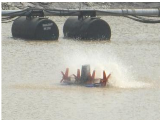
Figura 5. Detalhe de aerador de pás (modelo Aquapás) em funcionamento no Recinto 4.
