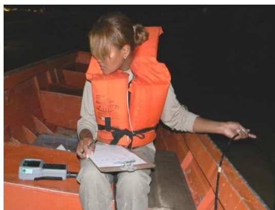
Figura 4. Monitoramento das variáveis limnológicas com sonda multiparâmetros.
