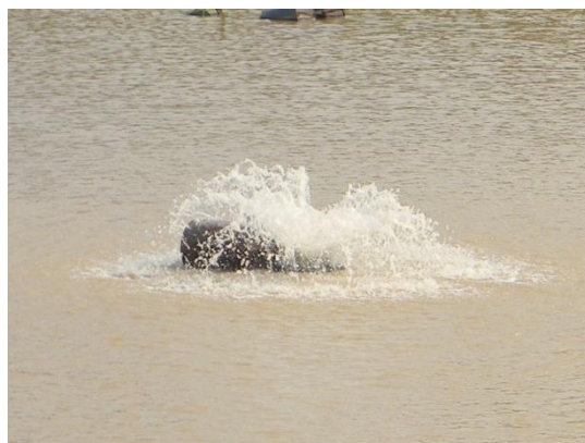
Figura 6. Detalhe de aerador de hélice (modelo Aquamix) em funcionamento no Recinto 4.
