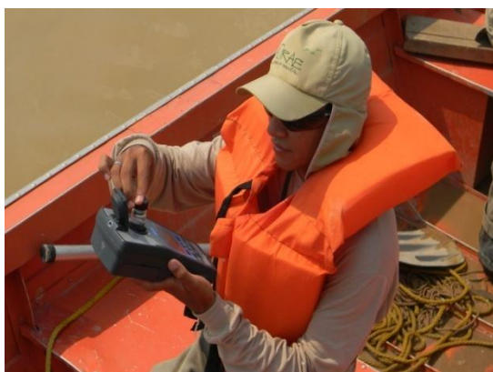
Figura 3. Monitoramento das variáveis limnológicas com turbidímetro no interior do Recinto 4.
