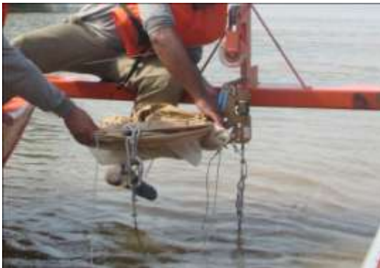
Figura 3. Detalhe do acoplamento da rede de icteoplâncton ao mecanismo de duplo estágio.
