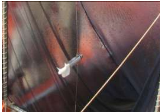
Figura 4. Detalhe do posicionamento do fluxímetro mecânico no centro da rede de coleta de juvenis.
