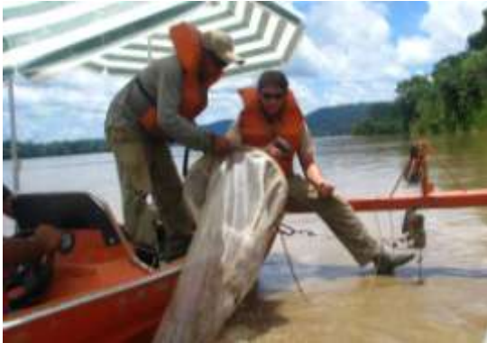
Figura 1. Utilização de rede icteoplâncton, com formato cônico-cilíndrico, para coleta de ovos e larvas.
