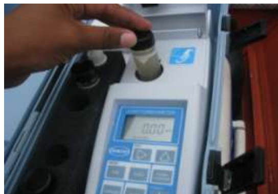
Figura 6. Utilização de turbidímetro para leitura da turbidez.
