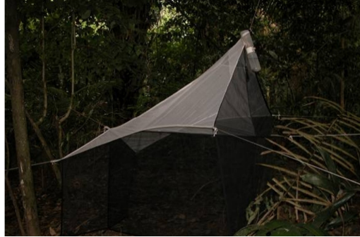
Figura 9-2 - Vista lateral da armadilha instalada através da fixação em árvores próximas
