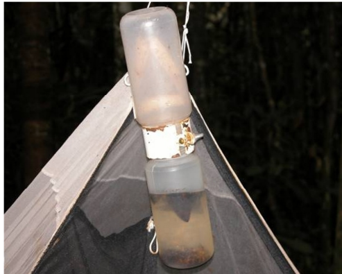
Figura 9-3 - Detalhe da câmara de vôo e do copo coletor de insetos contendo álcool.
