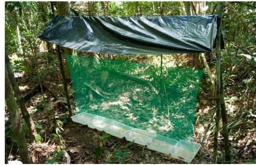
Figura 6-2 - Detalhe da cobertura de lona para proteção contra chuva.
