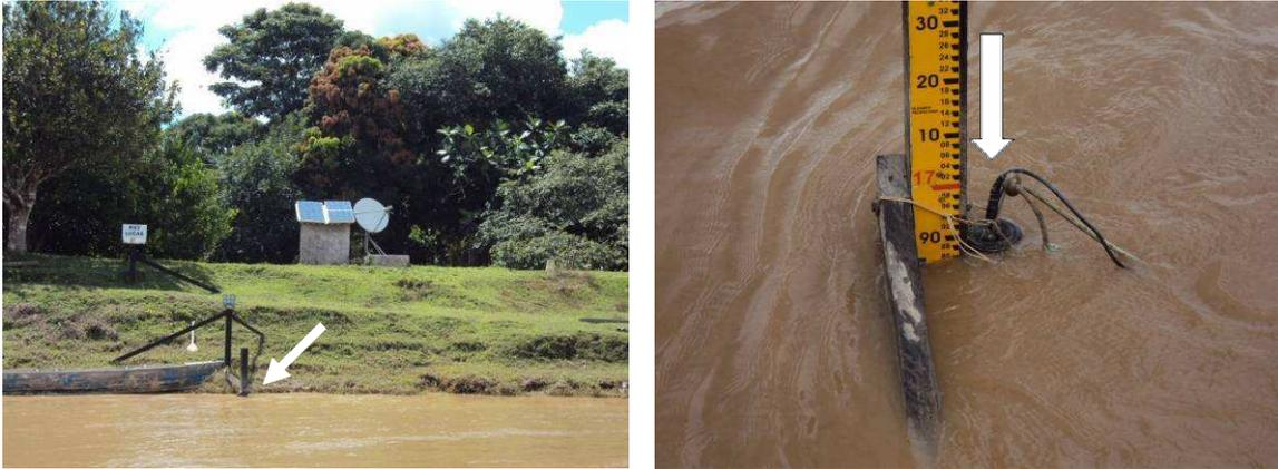
**Figura 46.** Local onde a sonda multiparamétrica do sistema de monitoramento em tempo real está fixada na margem direita do rio Madeira (RS 3 - Lucas), a jusante da futura barragem do AHE Jirau. As setas indicam o ponto no qual a sonda multiparamétrica permanece fixada.
