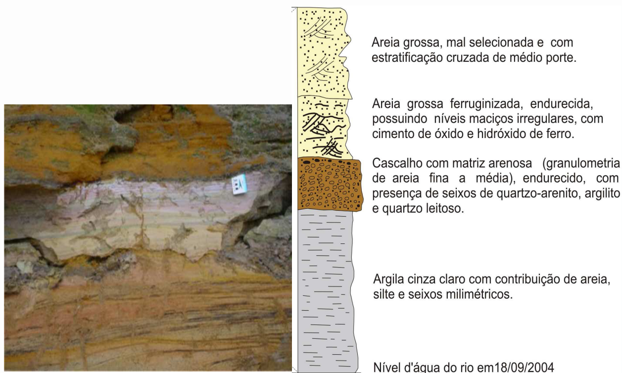
Figura 3 – (esquerda) Argilas siltosas e silte no nível inferior e areia ferruginosa na parte superior. Formação Rio Madeira. (Direita) Perfil esquemático da Formação Rio Madeira.
