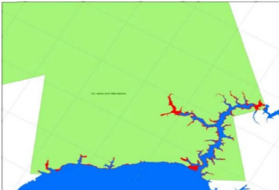
Figura 06 - Áreas afetadas (em vermelho) na Estação Ecológica Serra dos Três Irmãos (134,37 ha) pelo reservatório na cota 70,5 m e 38.838 m³/s.
