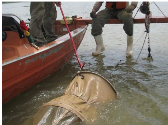
Figura 70. Utilização de rede ictioplâncton, com formato cônico-cilíndrico, para coleta de ovos e larvas.
