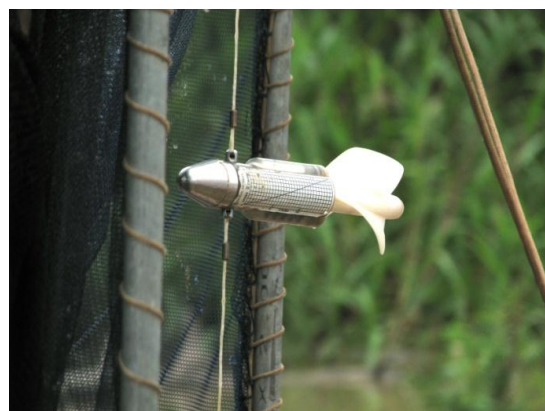
Figura 73. Detalhe do posicionamento do fluxímetro mecânico no centro da rede de coleta de juvenis.
