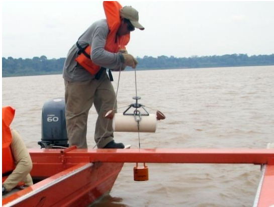
Figura 76. Utilização de garrafa tipo Van Dorn para coleta de água em diferentes profundidades.
