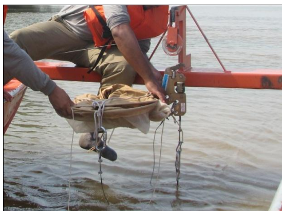
Figura 72. Detalhe do acoplamento da rede de ictioplâncton ao mecanismo de duplo estágio.
