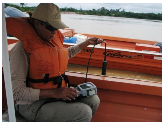
Figura 74. Utilização de sonda multiparâmetros para leitura dos parâmetros limnológicos.
