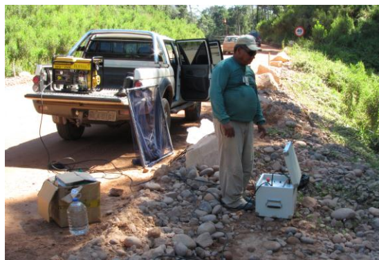
Figura 11. Equipamento de pesca elétrica sendo utilizado pela equipe do PCI do AHE Jirau.
