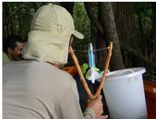
Figura 18. Fluxímetro mecânico utilizado para obtenção da velocidade da água.
