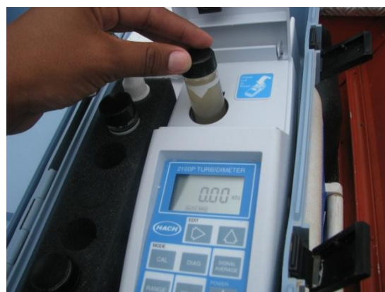
Figura 75. Utilização de turbidímetro para leitura da turbidez.
