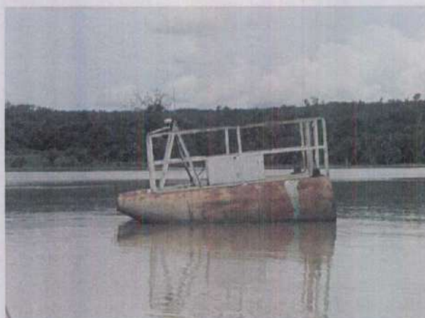
Figura 42: Estação de Monitoramento em Tempo Real localizado no reservatório á montante da UHE Jirau.
