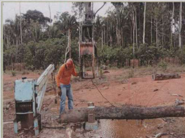
Figura 05: Arraste de madeira com o auxílio de cabos de aço - Igarapé São Lourenço.
