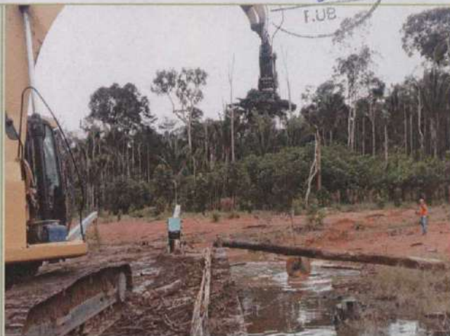
Figura 06: Arraste de madeira com o auxílio de cabos de aço - Igarapé São Lourenço.
