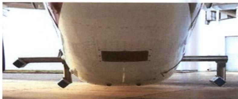
Figura 10 – Antenas de Banda X do RADAR SAR da BRADAR Instaladas na Aeronave
