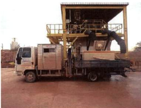
Figura 1. Caixa para transporte de peixes vivos, com capacidades de 2.400 litros, colocada sobre o caminhão.
