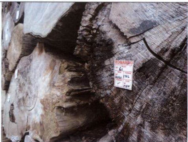
Figura 17: Toras da pilha 61 do pátio P1E01 com baixa qualidade para serraria.
