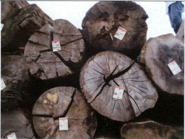
Figura 17: Vista de toras com rachaduras proeminentes no pátio P1D01.
