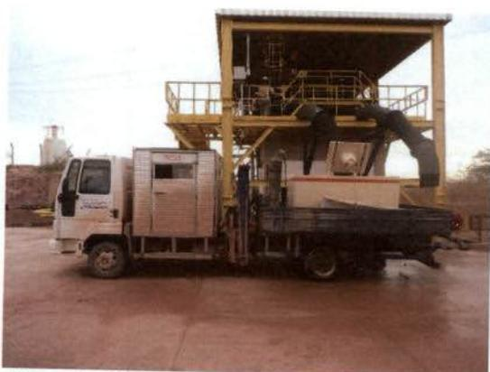
Figura 1. Caixa para transporte de peixes vivos, com capacidades de 2.400 litros, colocada sobre o caminhão.
