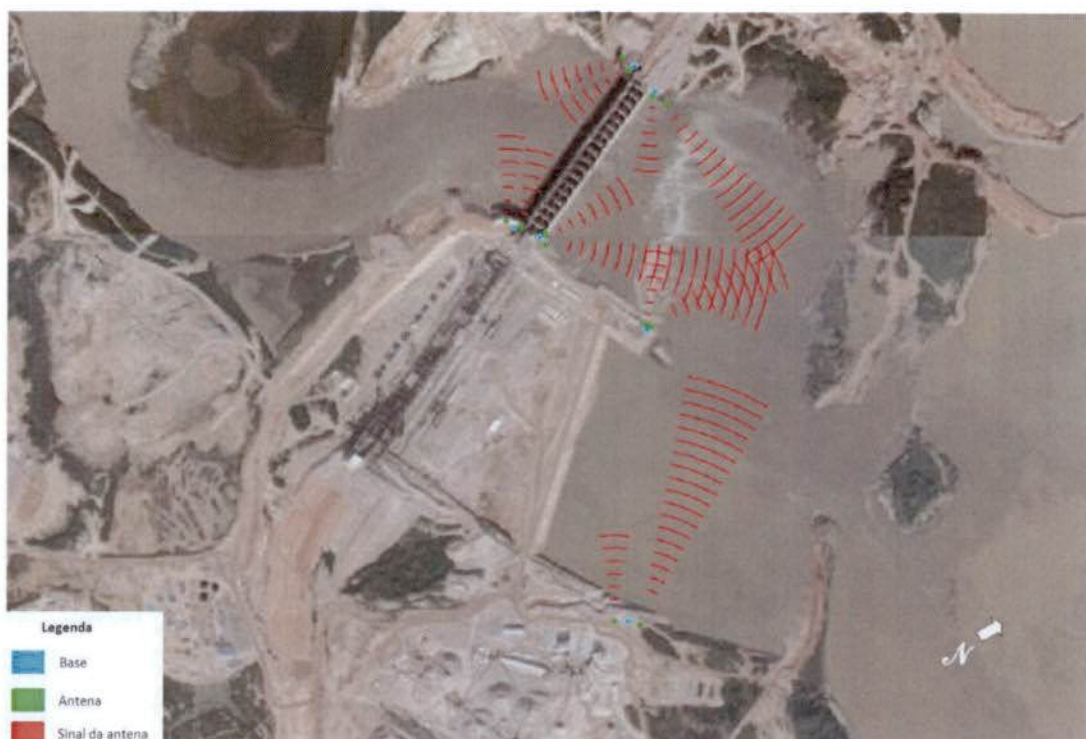
Figura 14. Área de cobertura estimada e posição das antenas aéreas para registro de peixes a jusante e a montante da UHE Jirau.
