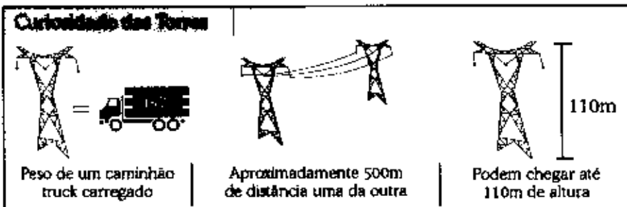
Dois modelos de torres estão sendo implantados nas Linhas de Transmissão de 500 kV - UHE JIRAU - SE Coletora de Porto Velho
