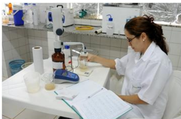
FOTO 2.9. 7: Análise de alcalinidade no laboratório instalado no canteiro de obras da UHE Santo Antônio – margem esquerda
