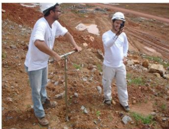
FOTO 2.6. 1: Amostragem de solo no bota-fora do canteiro de obras UHE Santo Antônio
