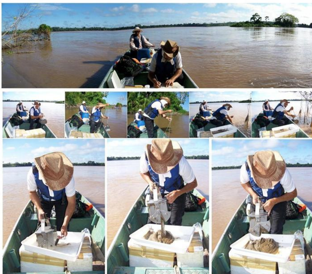
PRANCHA 2.6. 2: Coleta de sedimento de fundo utilizando draga de Eckman para análise metais pesados.
