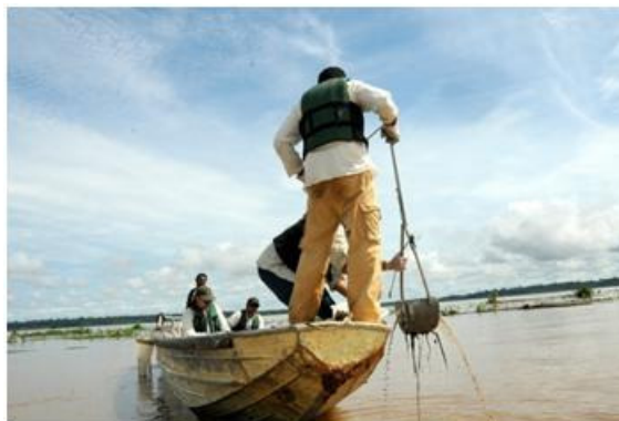
FOTO 2.9. 3: Procedimento de amostragem de sedimento
