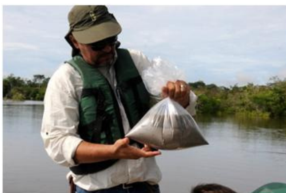
FOTO 2.9. 5: Amostra de sedimento para análise de invertebrados bentônicos
