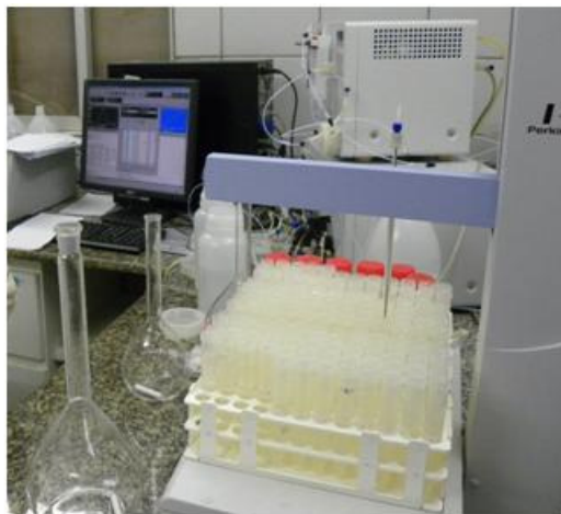
FOTO 2.6. 6: Análise de Mercúrio – leitura no FIMS (Flow Injection Mercury System-400, Perkin Elemer)
