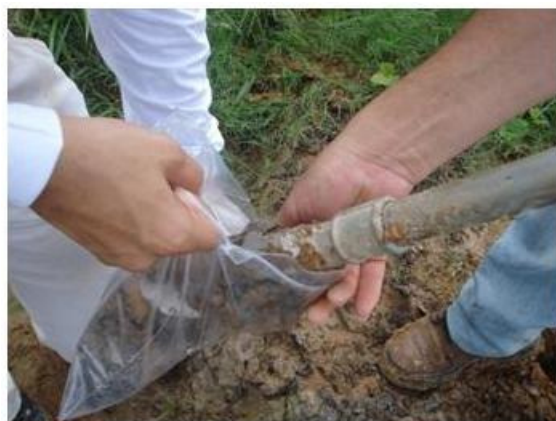
FOTO 2.6. 2: Amostragem de solo no bota-fora do canteiro de obras UHE Santo Antônio
