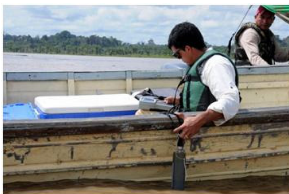
FOTO 2.9. 10: Procedimento de leitura de pH, OD, temperatura e CE em perfil da coluna d'água, por meio de sonda multiparâmetro
