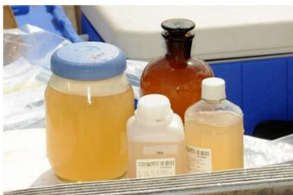
FOTO 2.9. 2: Frascos com amostras de água para diferentes análises – a ser encaminhado para o laboratório
