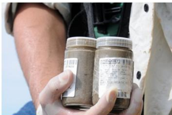
FOTO 2.9. 1: Frascos com amostras de sedimento para análises químicas – a ser encaminhado para o laboratório
