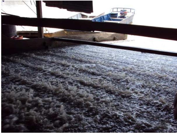
Foto 13 – Caixa encarpetaada utilizada nas balsas.
