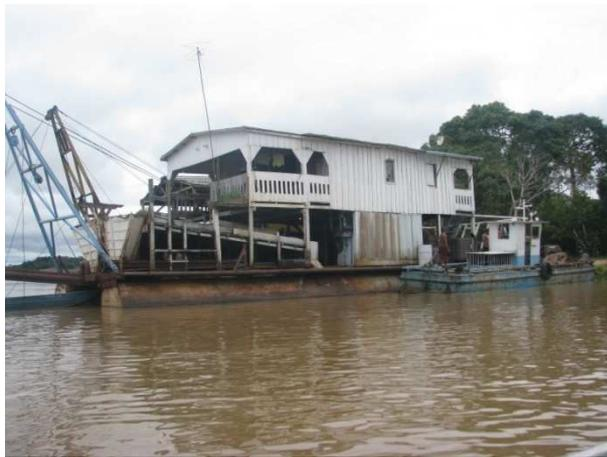
Foto 3 – Embarcação do tipo draga em operação.
