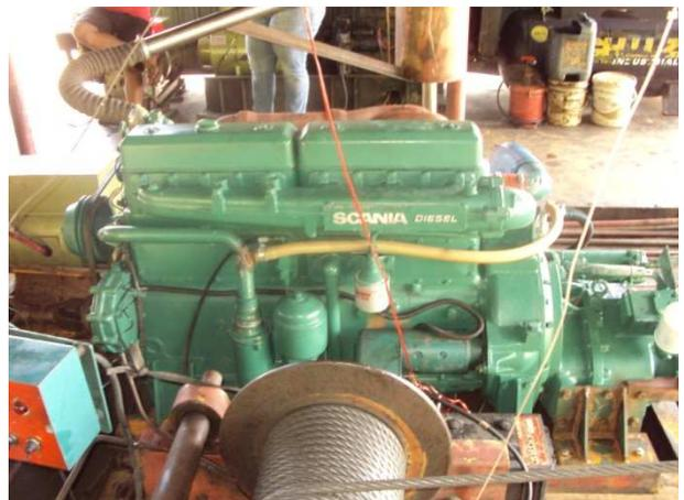
Foto 6 – Equipamento motor, utilizado em draga.
