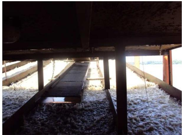
Foto 8 – Caixa encarpeta para retenção de ouro.
