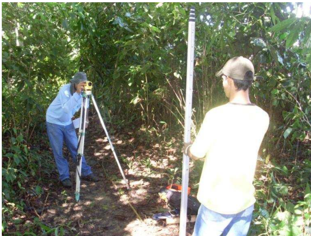
Figura 3.2. Levantamento do Perfil Topográfico do Local de Monitoramento 1
