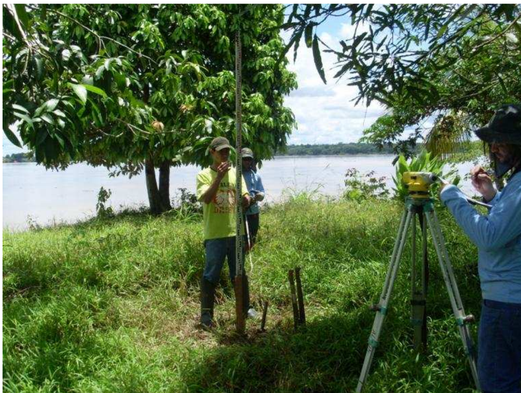
Figura 3.9. Levantamento do Perfil Topográfico do Local de Monitoramento 3
